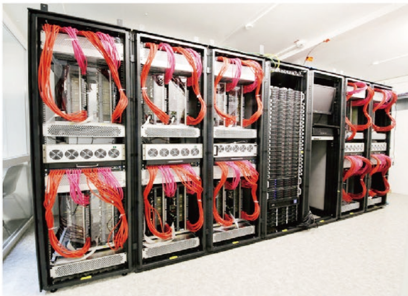
BrainScaleS机柜组。每组含5个机柜，每个机柜容纳4片晶圆。图片来源：海德堡大学
